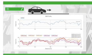
ข้อมูล IRI (ค่าดัชนีความเรียบขรุขระสากล)
